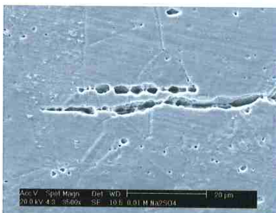
Figura 12 - Detalhe da figura 11. É possível perceber que a cavidade ocorre de maneira transgranular.
