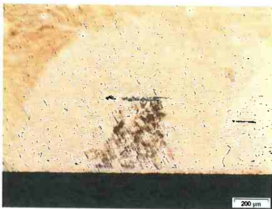
Figura 5 - Aspecto da morfologia de corrosão após polarização anódica em 10^{-2} \text{ mol.L}^{-1} \text{ Na}_2\text{SO}_4 , acabamento superficial de 3\mu\text{m} . Cavidades alongadas.
