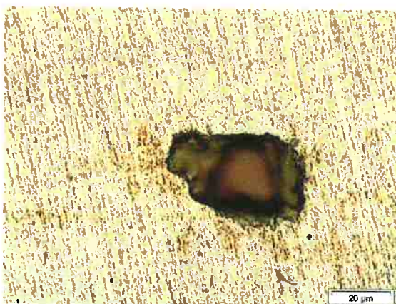
Figura 7 - Detalhe da morfologia das cavidades isoladas (pites).
