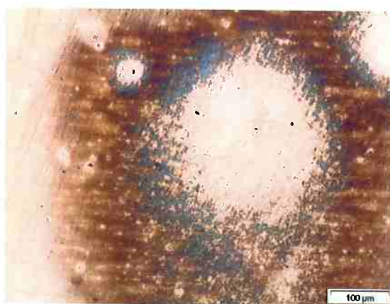
Figura 21 - Detalhe da morfologia de corrosão após polarização anódica em 10^{-2} \text{ mol.L}^{-1} \text{ Na}_2\text{SO}_4 com adição de 10^{-1} \text{ mol.L}^{-1} \text{ NaCl} . Acabamento 3 \mu\text{m} .
