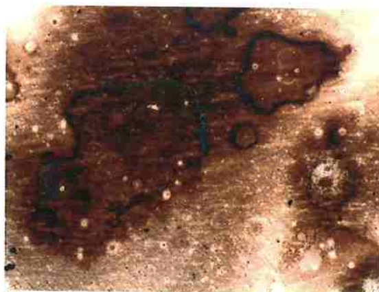
Figura 23 - Morfologia de corrosão após polarização anódica em 10^{-2} mol.L -1 Na 2 SO 4 com adição de 5 \cdot 10^{-3} mol.L -1 NaCl. Acabamento 3μm.
