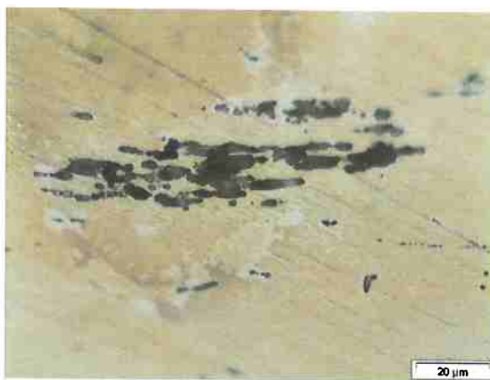
Figura 6 - Aspecto da morfologia de corrosão após polarização anódica em 10^{-2} \text{ mol.L}^{-1} \text{ Na}_2\text{SO}_4 , acabamento superficial de 3\mu\text{m} . Detalhe das cavidades alongadas.
