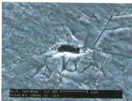
Figura 27 - Detalhe da cavidade apresentada na micrografia à esquerda. Abertura da cavidade por volta de 4 \mu\text{m} .
