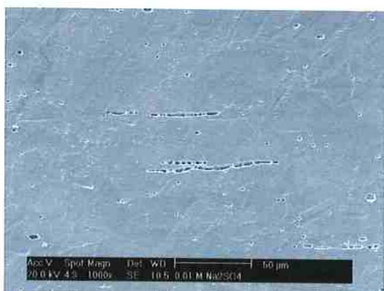
Figura 11 - Superfície corrida após polarização em solução 10^{-2} mol.L -1 Na 2 SO 4 . Apresenta pites com morfologia alongada e microestrutura levemente revelada.
