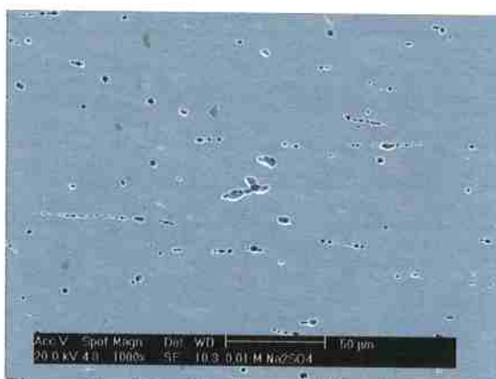
Figura 9 - Aspecto da superfície da amostra após polarização em solução 10^{-2} mol.L -1 Na 2 SO 4 . Diversos pites podem ser observados manifestando-se com geometria regular.
