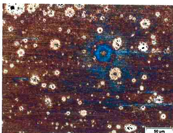
Figura 25 - Morfologia de corrosão após polarização anódica em 10^{-2} mol.L -1 Na 2 SO 4 com adição de 10^{-2} mol.L -1 NaCl. Acabamento 3μm.
