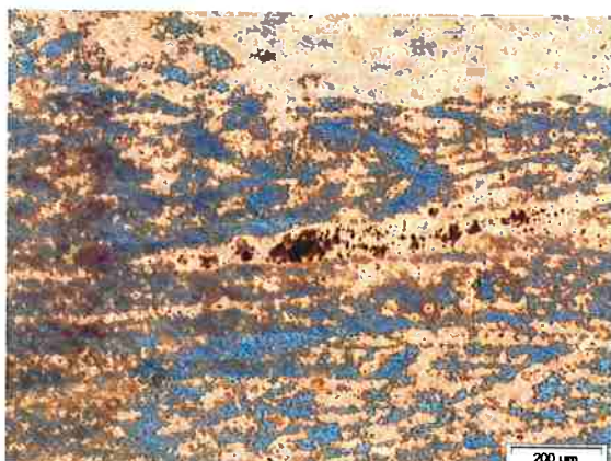
Figura 15 - Aspecto da superfície após polarização anódica em 10^{-2} mol.L -1 Na 2 SO 4 com adição de 10^{-1} mol.L -1 NaCl. Acabamento superficial de 3µm. Verifica-se ataque generalizado e ausência de cavidades.
