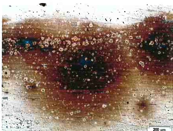
Figura 24 - Morfologia de corrosão após polarização anódica em 10^{-2} mol.L -1 Na 2 SO 4 com adição de 10^{-2} mol.L -1 NaCl. Acabamento 3μm.
